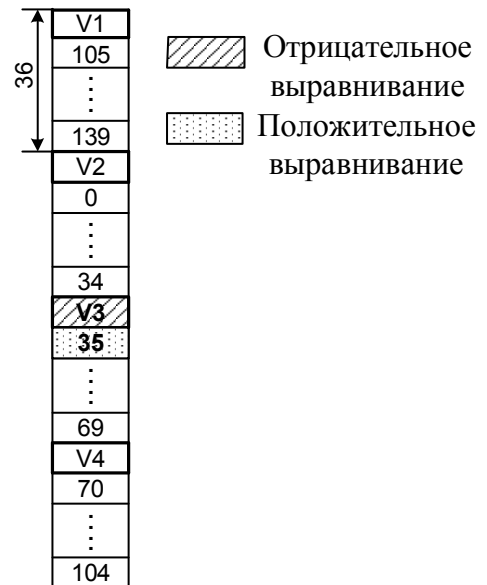
Рис. 3.29. Нумерация указателя TU-12
