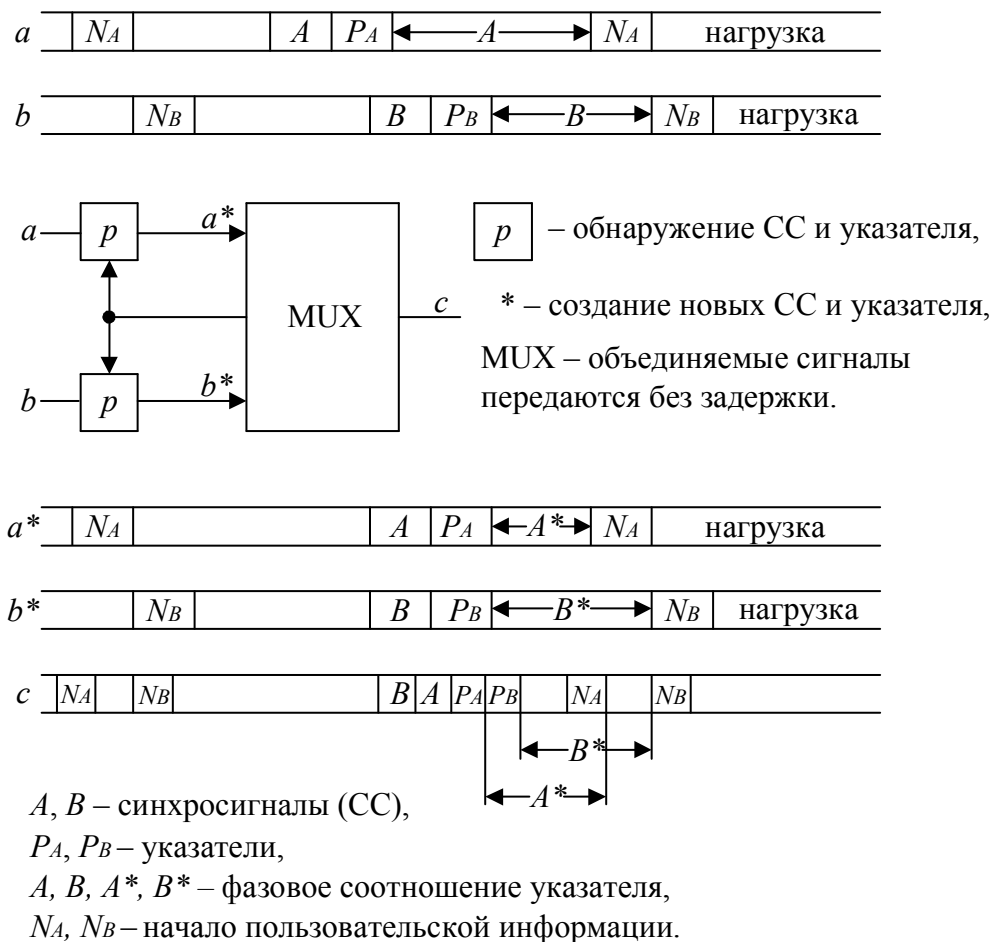
Рис. 3.1. Принцип объединения цифровых потоков с использованием указателей
